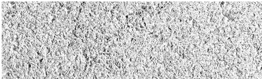
Manuell mit Knüpfel und Scharriereisen überarbeitet. Bildmassstab 1:1
