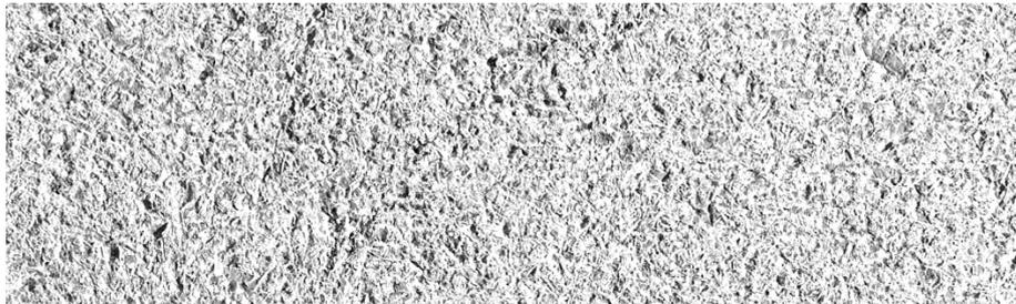
Finition avec ciseau ou laie pneumatique ; la texture qui en résulte est semblable à celle obtenue avec un reparoir fin ou une laie. Échelle de l'image 1:1
