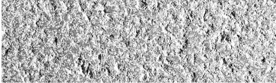
Finition au marteau pneumatique à aiguilles. Échelle de l'image 1:1
