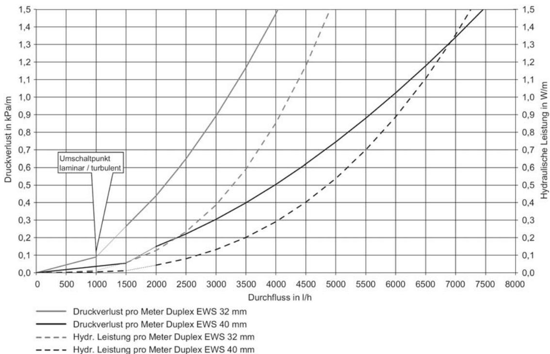
Figur 26 Druckverlust und hydraulische Leistung pro Meter EWS bei **Propylenglykolgemisch 25%** bei 0 °C (Viskosität 6,0 mm<sup>2</sup>/s, 1033 kg/m<sup>3</sup>)
