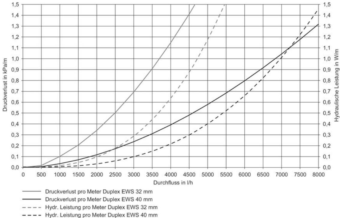
Figur 23 Druckverlust und hydraulische Leistung pro Meter EWS bei **Ethylenglykolgemisch 20%** bei 0°C (Viskosität 3,5 mm<sup>2</sup>/s, 1040 kg/m<sup>3</sup>)
